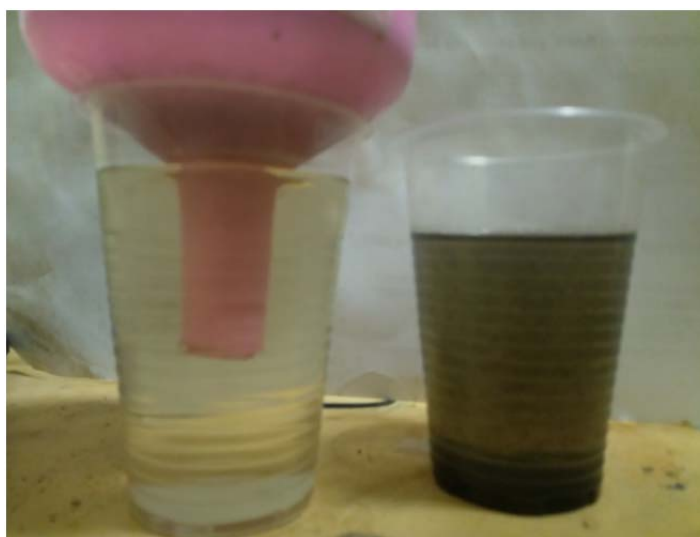
Рисунок 1. – Изменение мутности и цвета растворов после процесса коагуляции
