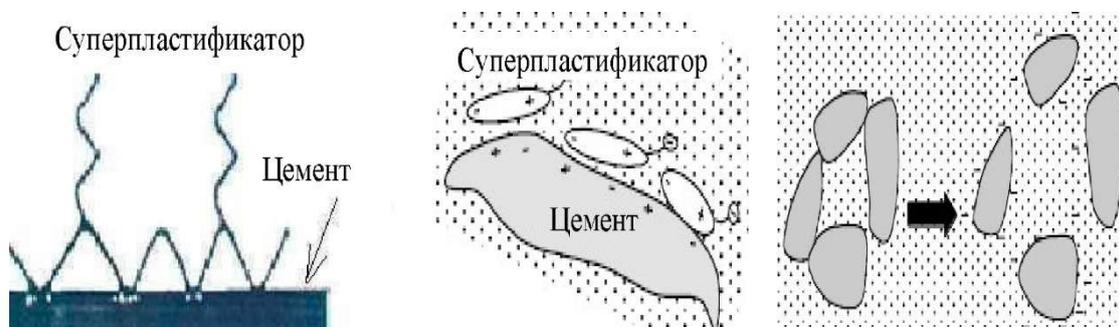
Рисунок 2. – Пластикация на растворимых цементных частицах
