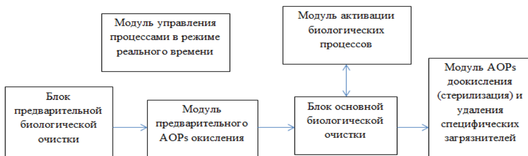
Рисунок – Системное комбинирование биологических процессов и AOPs при очистке сточных вод (усреднители, песколовушки и другие элементы предочистки не указаны)
