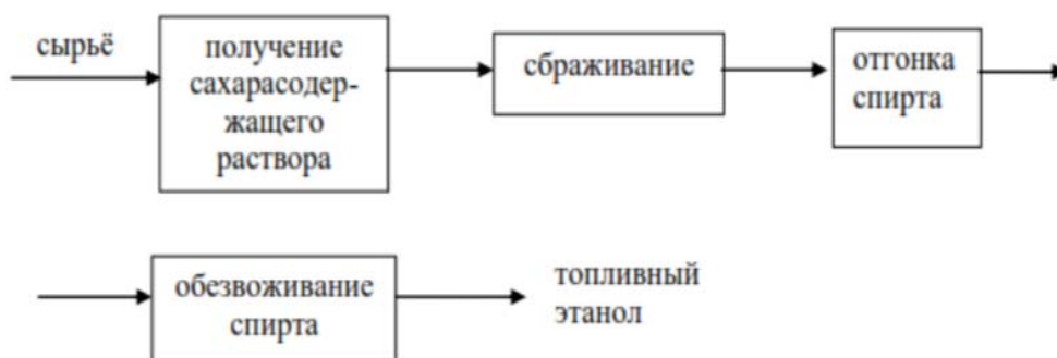
Рисунок – Схема технологического процесса производства этанола из сахаросодержащего сырья
